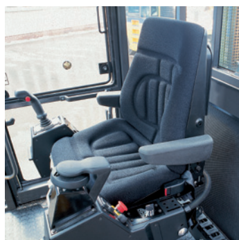
Подвижное и поворотное рабочее место оператора с интегрированными элементами управления
